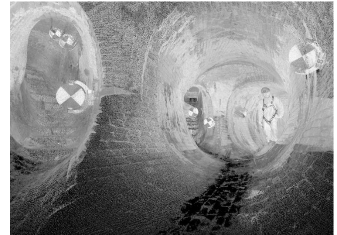
Abb. 2: Punktwolke (Verknüpfung der Einzelscans)
